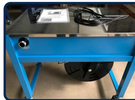
**Placa superior articulada de aço inoxidável:** Com sua placa superior articulada em aço inox, esta máquina não só resiste ao desgaste diário, mas também facilita o acesso para limpeza e manutenção, aumentando a eficiência e prolongando a vida útil do equipamento.
